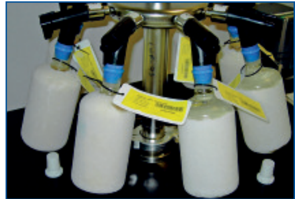
Figura 18. Proceso de liofilización de un extracto de Olea europaea . El producto permanece a temperaturas inferiores a -60^{\circ}\text{C} , y en condiciones absolutas de vacío
